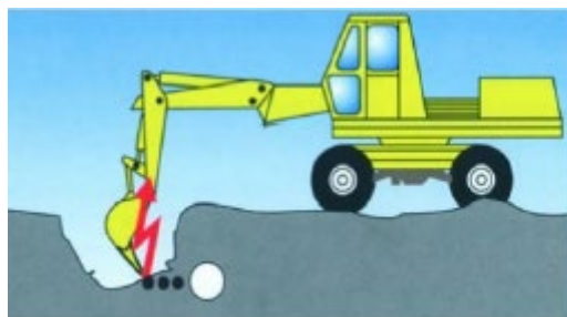
Abbildung 1 Beschädigung eines Stromkabels
